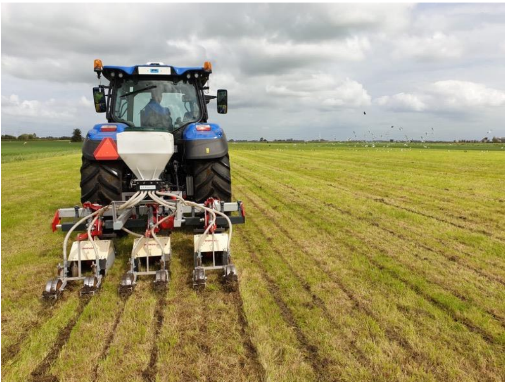
Figuur 8 Foto van het doorzaaien bij Gert-Jan de Graaf, waar gebruik werd gemaakt van een strokenfrees, een kansrijke nieuwe machine
